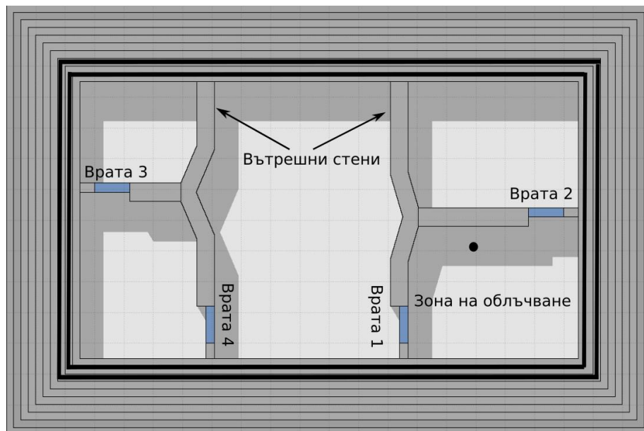
Фиг. 1. Геометричен модел на защитния бункер на циклотрона (поглед отгоре).
